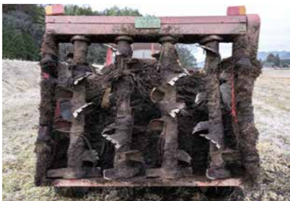
「左の7頁下段の写真」の堆肥散布トレーラー最後尾の堆肥の出口です。熟成した堆肥はこの出口で細かく攪拌され、堆肥では足りない成分も補い牧草地に散布されます。
