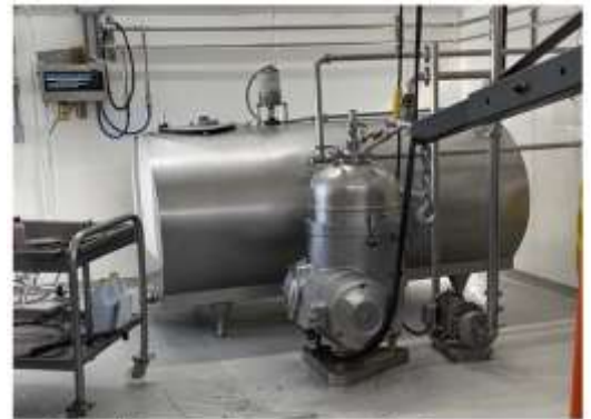
チーズホエイをクリームとホエイに分離するセパレーター
