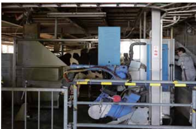
徳本牧場で使用されている搾乳ロボット
